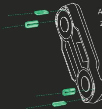
Achte darauf, die vier „Bumper“ nicht zu verlieren, wenn Du den Connector von der Flasche löst. Sollte sich ein Bumper lösen, einfach wieder in die entsprechenden Ecken des Connectors einschieben.
