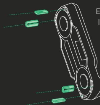
En détachant le connecteur de la bouteille, s'assurer de ne pas perdre les « bumpers ». Si un de ces « bumpers » en venait à se détacher, il faut simplement l'enfoncer de nouveau dans le coin correspondant.
